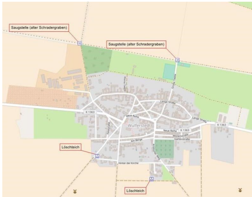
Abbildung 65: derzeitige unabhängige Löschwasserentnahmestellen in Wulferstedt
