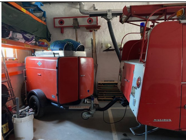
Abbildung 152: die nicht ausreichende Länge der Fahrzeughalle führt dazu, dass der Schlauchtransport-/Logistikanhänger schräg hinter dem Fahrzeug steht
