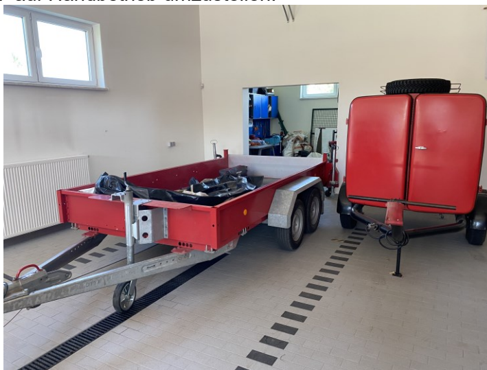
Abbildung 168: die Stellplatzlänge ist im Feuerwehrhaus Kroppenstedt nicht ausreichend für die Aufnahme der Anhänger (hinter den Fahrzeugen) während die Bewegungsräume ausreichend dimensioniert sind.
