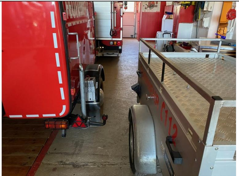
**Abbildung 90: Die Abstände zwischen den Fahrzeugen / Anhängfahrzeugen sind deutlich zu gering**
