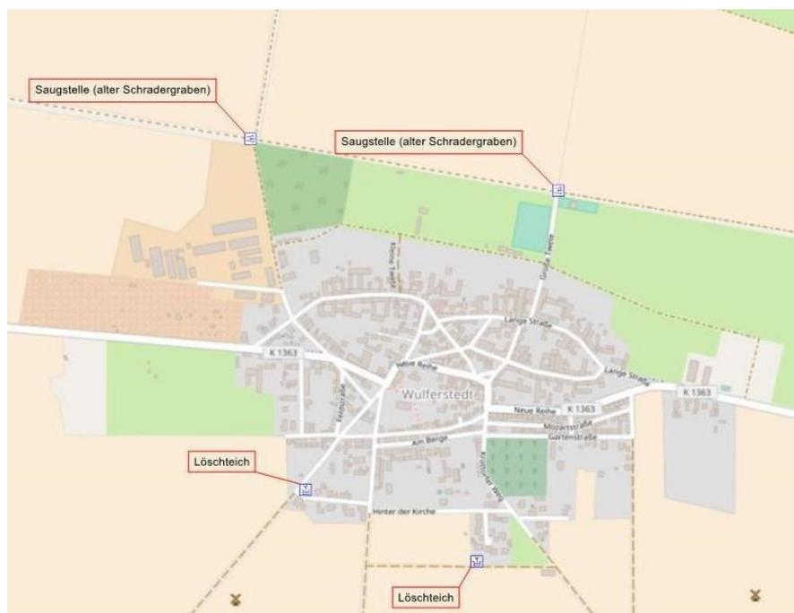
**Abbildung 65: derzeitige unabhängige Löschwasserentnahmestellen in Wulferstedt**
